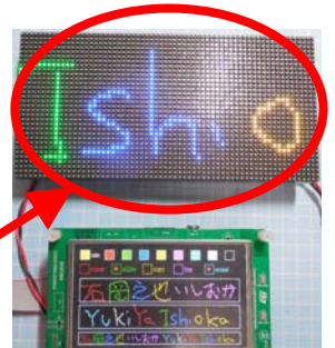
copy ボタンで表示フレームへの反映と LED マトリックスへ出力
